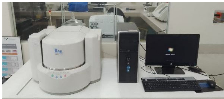
Graphique 37. Équipement de fluorescence X à énergie dispersive.
